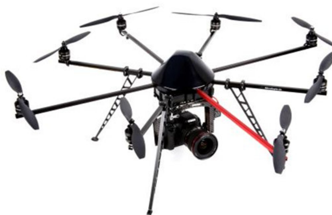
Fig. 2: Okto XL, de Mikrokopter, segunda aeronave no tripulada a usar en el proyecto.
