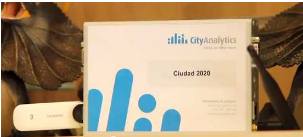
Fig. 3. Dispositivo Intelify con el modem USB para conexión 3G conectado.
