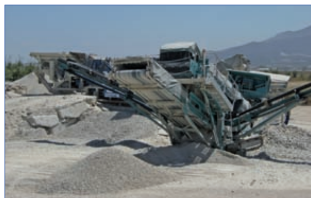
Foto 3. Fabricación de áridos reciclados a partir de RCD.
