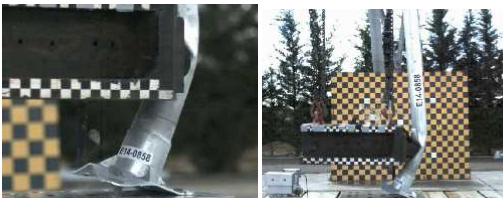
Fig. 5: Fotogramas de detalle (izq) y general (der) de una farola que NO rompe por la entalla.
