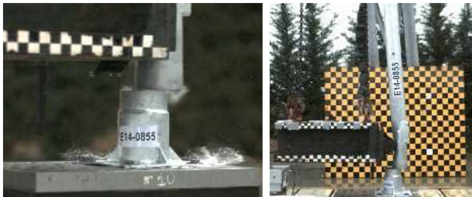
Fig. 4: Fotogramas de detalle (izq) y general (der) de una farola que SI rompe por la entalla.
