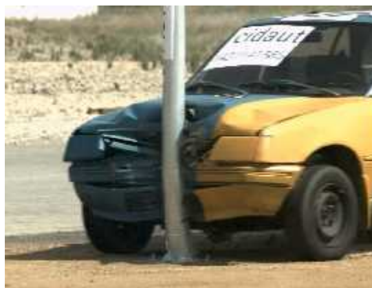
Fig. 7: Fotograma del impacto del vehículo normalizado en el ensayo según UNE-EN 12767
