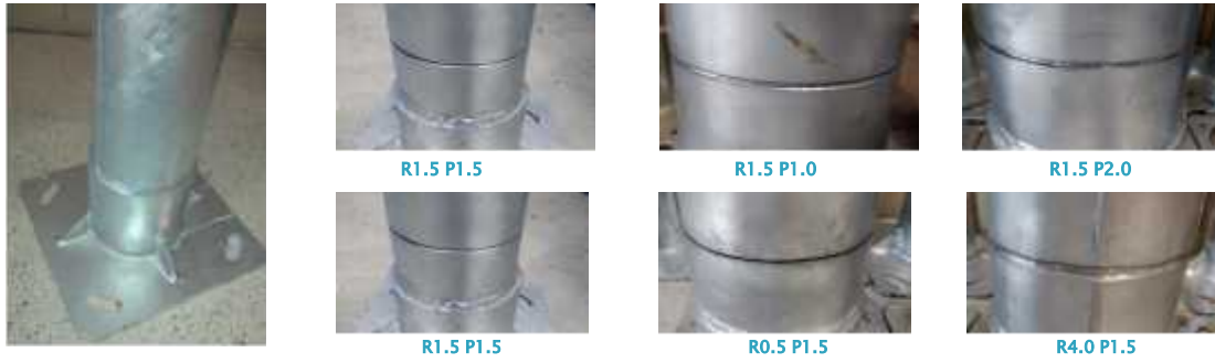
Fig. 3: Base de la farola (izq) y entallas realizadas (R=radio y P=profundidad, en mm)
